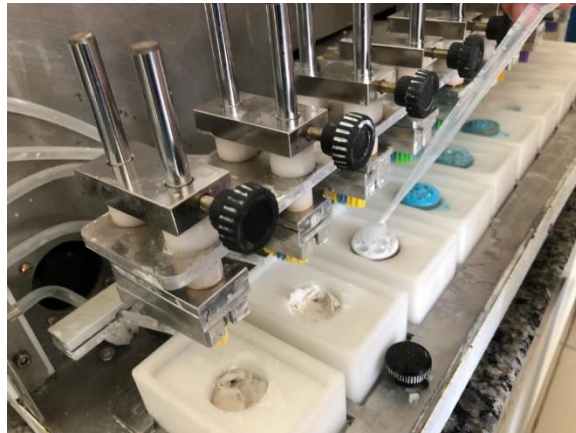
Fig 4- Máquina de escovação (ODEME MEV e T – 10XY)
