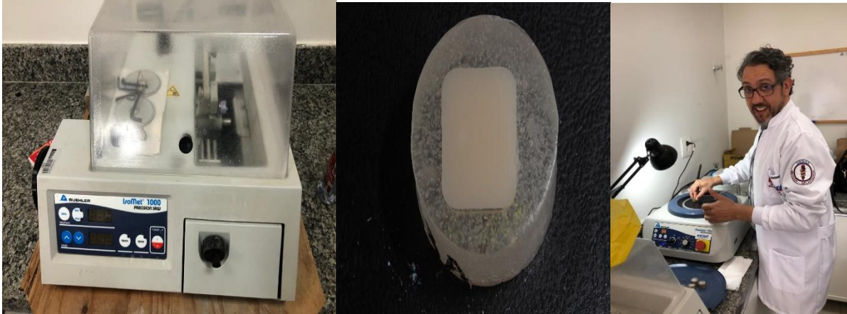
Fig. 2 - Cortadeira metalográfica (Isomet 1000, Buheler) + Amostras incluídas em acrílico transparente + regularização da superfície
