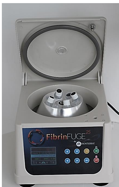
Figura 5 - Posicionamento dos tubos dentro da centrífuga FibrinFUGE 25. Fonte: Autora, 2022.
