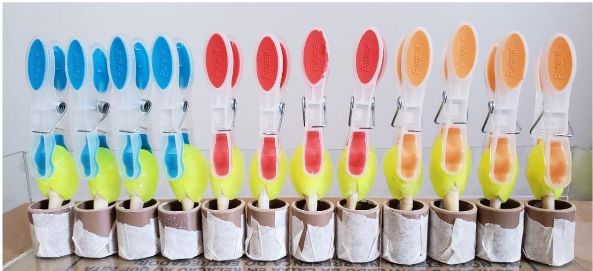
Figura 2 – Os anéis de PVC com os dentes posicionados, prontos para ser preenchidos com resina acrílica.
