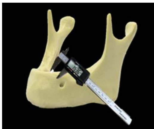
Figura 3. Representação do uso do paquímetro digital para obtenção da mensuração real (padrão-ouro) de altura e espessura óssea na mandíbula sintética.
