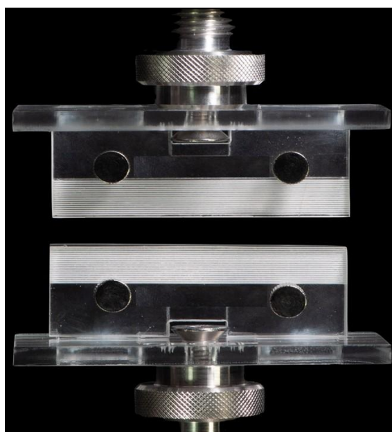
Figura 3 - Dispositivo desenvolvido para fixação do conjunto amostra-suporte na máquina de ensaio universal
