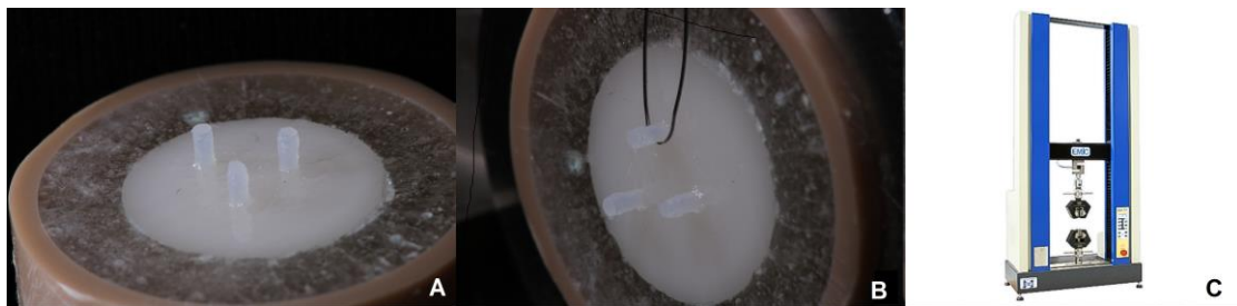
Figura – 7 A) Cilindros de cimento resinoso. B) Máquina de ensaio universal EMIC DL 500. C) Amostra posicionada na máquina de ensaio com fio de aço em torno do cilindro para teste de resistência de união.
