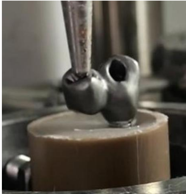
Figura 4: Corpo de Prova posicionado no simulador de fadiga Fonte: O autor (2020)
