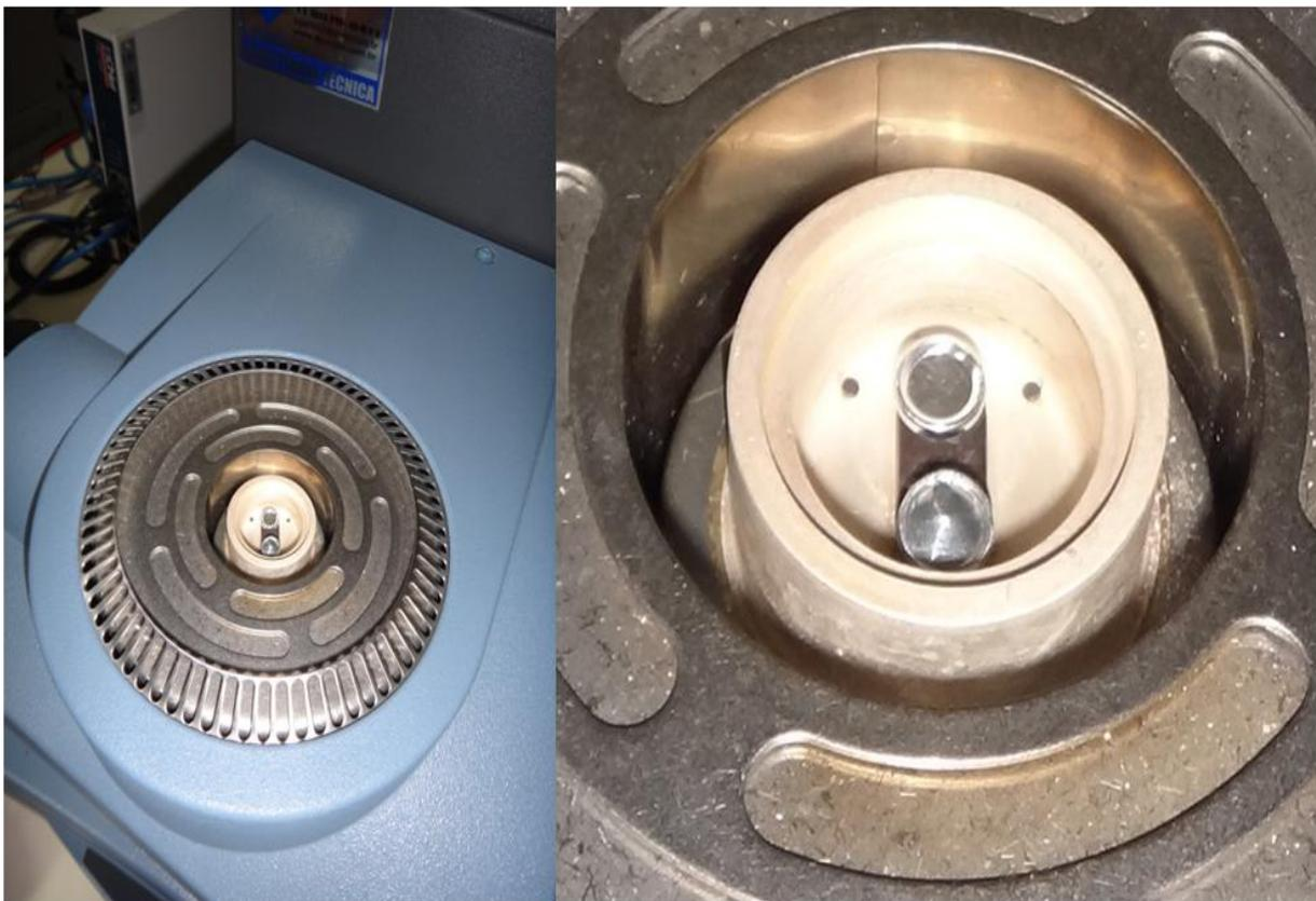
**Figura 6** – Cadinhos de alumínio inseridos na máquina de DSC.
