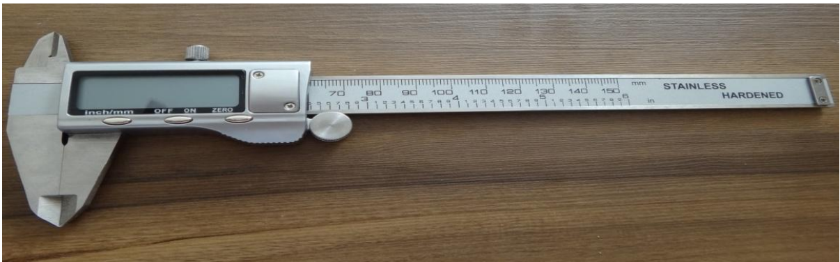
Figura 2 – Paquímetro digital de precisão centesimal, utilizado nas medições dentárias.
