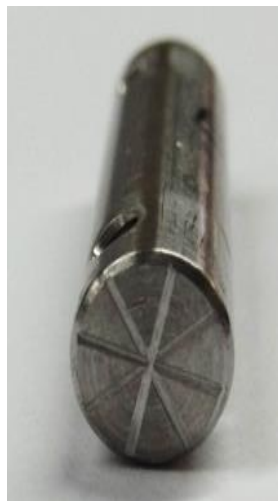
Figura 5: Cilindro metálico com ranhuras para adaptação dos bráquetes.
