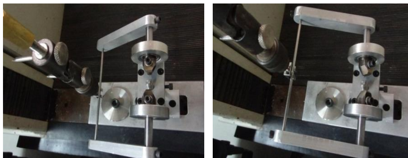
Figura 15: Dispositivo de torção antes e depois da torção realizada
