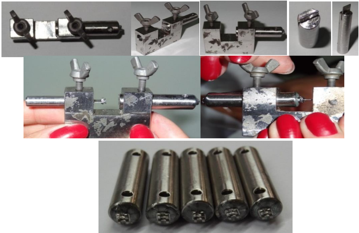
Figura 8: Dispositivo de colagem com calibrador
