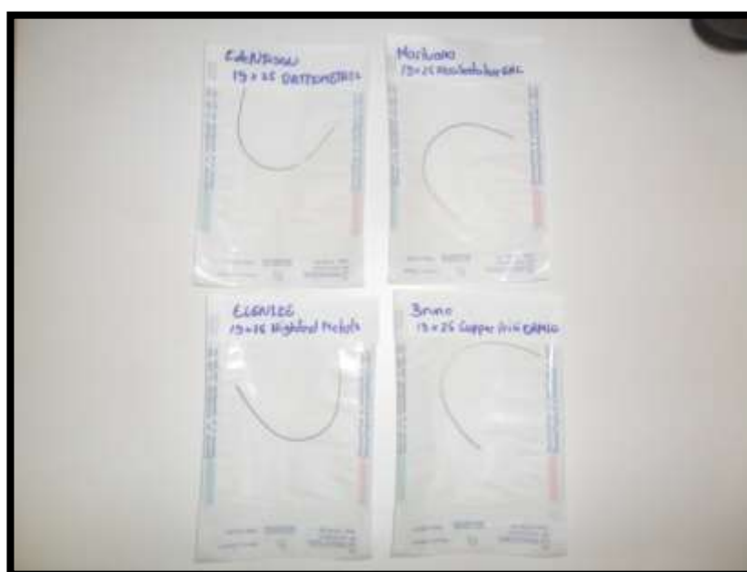
Figura 12: Fios de níquel-titânio submetidos à esterilização em autoclave.
