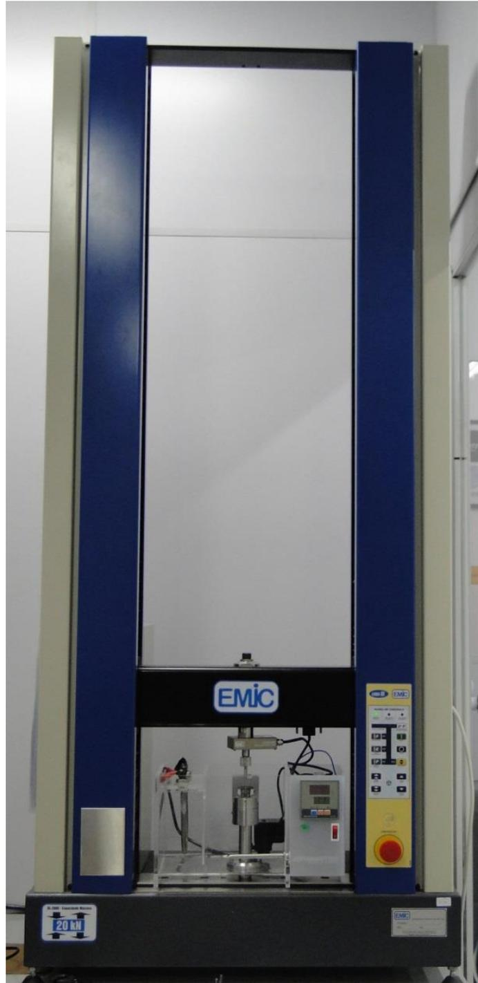
**Figura 8** – Máquina de ensaio universal da marca EMIC, modelo DL 2000, São José dos Pinhais – S.P.
