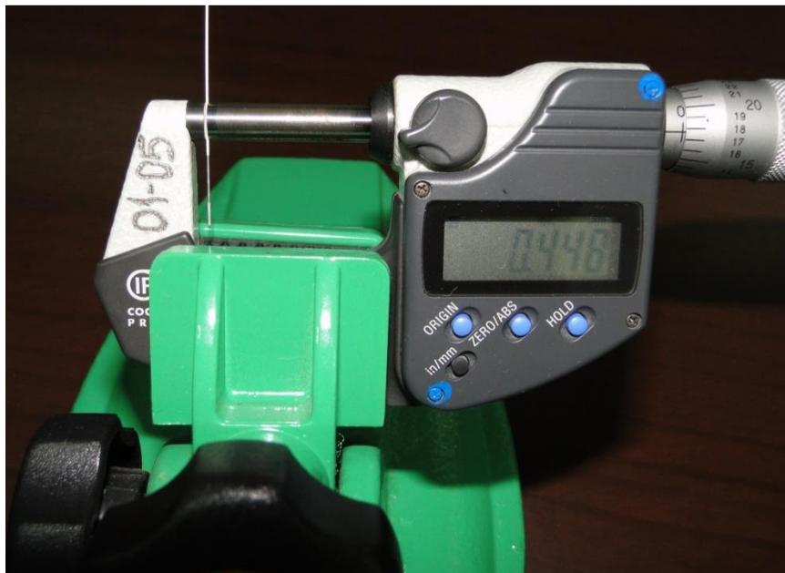
**Figura 3** – Apreensão e obtenção da leitura do diâmetro do fio na região com cobertura.
