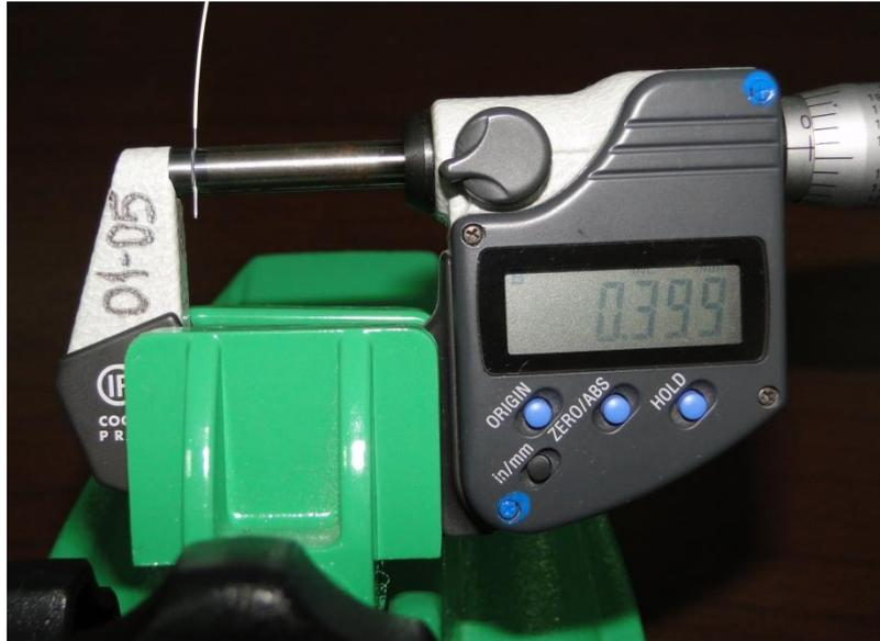
**Figura 2** – Apreensão e obtenção da leitura do diâmetro do fio na região sem cobertura.
