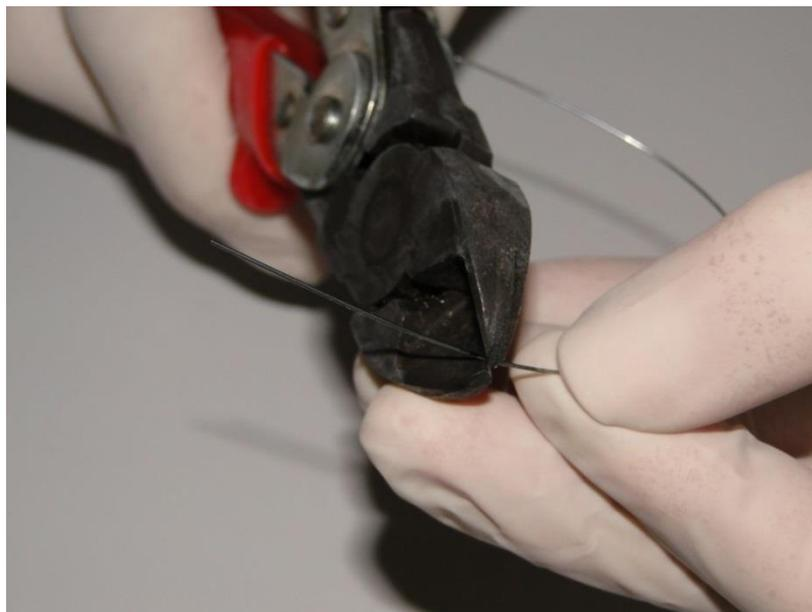
**Figura 5** – Corte dos corpos de prova com alicate Dentaureum.
