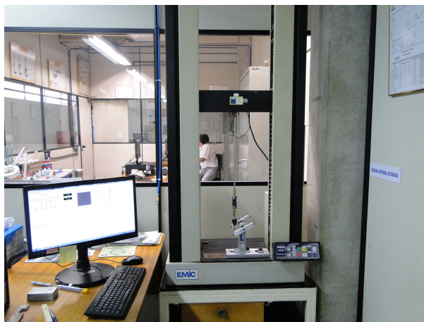
Figura 6: Máquina Universal de Ensaio com dispositivo adaptado.
