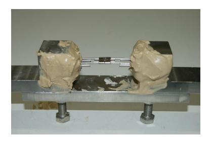
**Figura 13**. Isolamento com gesso pedra, para a proteção da conexão entre chave, miniimplante e osso durante a soldagem.
