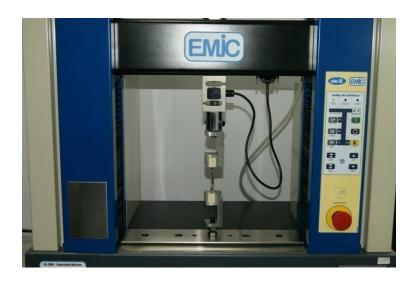
**Figura 19**. Adaptação do conjunto de bases metálicas de zero (0º) grau de angulação, com o corpo de prova também adaptado.
