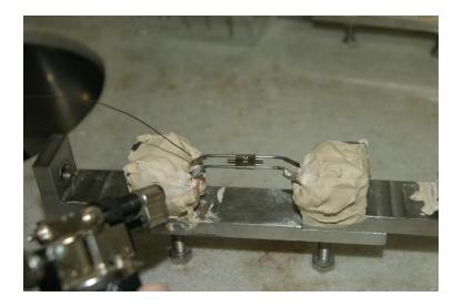
Figura 14. Soldagem para união do parafuso expansor aos intermediários.
