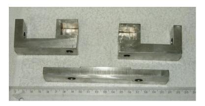
**Figura 5**. Conjunto de bases metálicas com angulação de 0º, sendo duas bases espelhos e um plano metálico de união.
