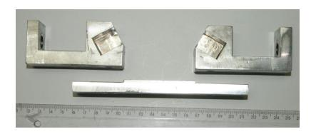
**Figura 6**. Conjunto de bases metálicas com angulação de 30º, sendo duas bases espelhos e um plano metálico de união.
