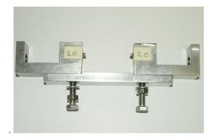
**Figura. 8**. Mostra a montagem dos blocos com mini-implantes nas bases de angulação zero grau (0°), reta.
