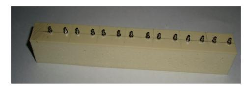
**Figura. 7**. Exibe a inserção de todos os mini-implantes no bloco, prévio aos cortes de separação dos mesmos.
