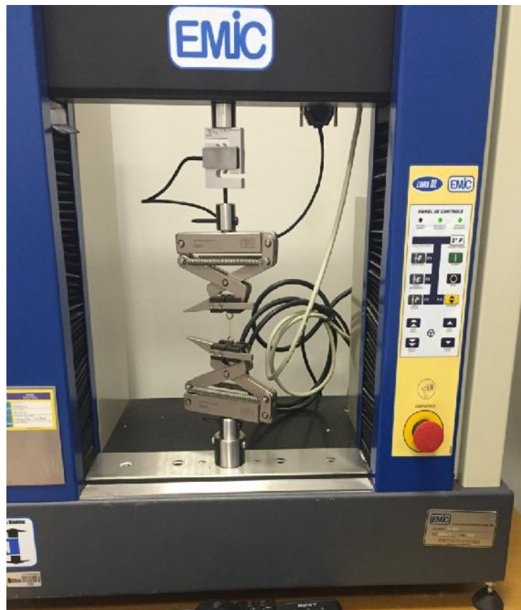
Figura 3: Máquina de Ensaio Universal EMIC DL500
