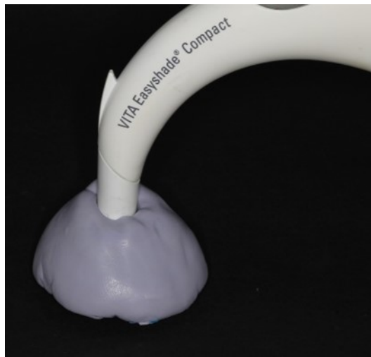
Figura 11 - Matriz de Silicone de Adição para calibrar o ângulo de leitura e anular a interferência de luz externa durante a leitura.
