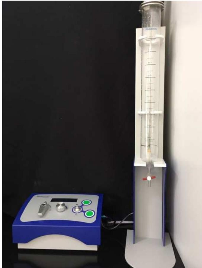
Figura 5 - Gerador de Ozônio; Coluna para ozonização da água
