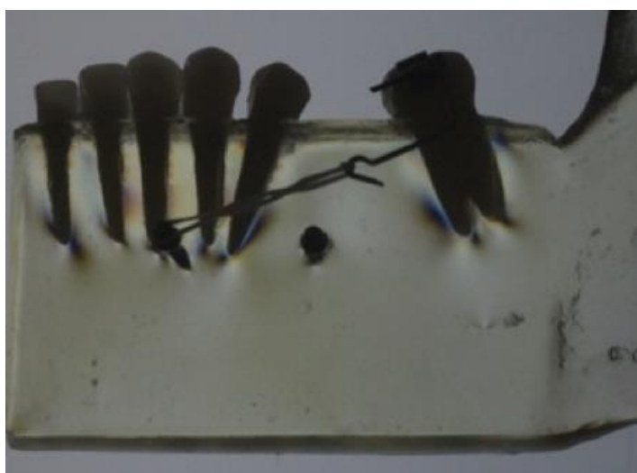
Figura 11 - Tensão gerada no protótipo do grupo 4
