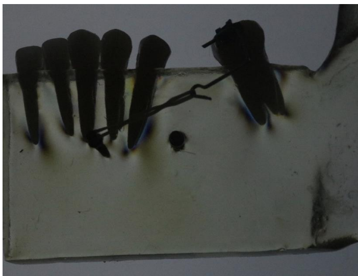
Figura 9 - Tensão gerada no protótipo do grupo 2
